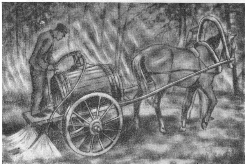
Рис. 32. Конный пожарный опрыскиватель ОБП.
