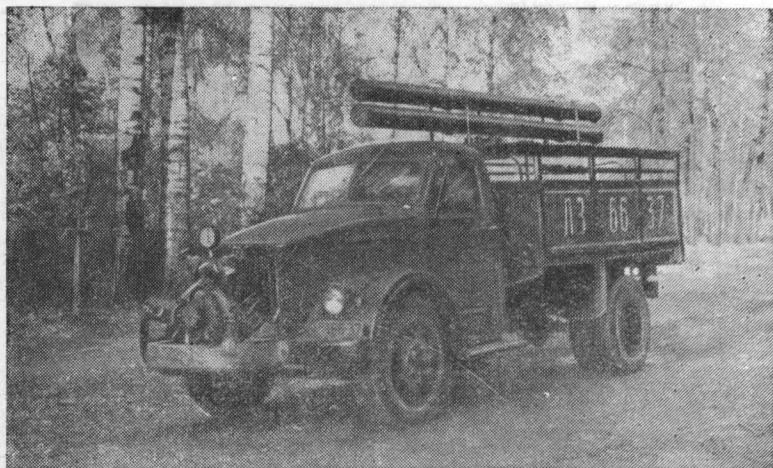
Рис. 33. Пожарная колесная автоцистерна ПЛАЦ.
